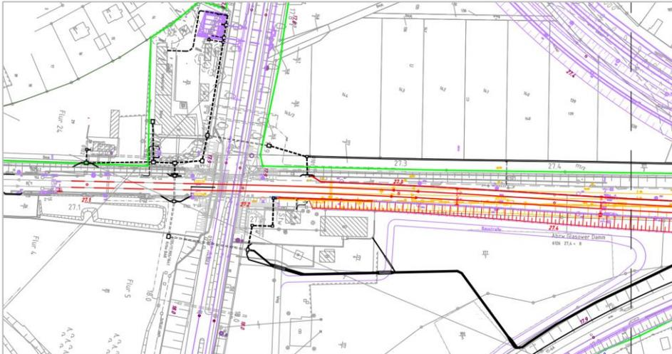
Abbildung 16: Auszug aus dem Lageplan der DB Netz AG (Ausführungsplanung) mit erkennbarer Verschwenkung der Gleisanlagen des BAR
