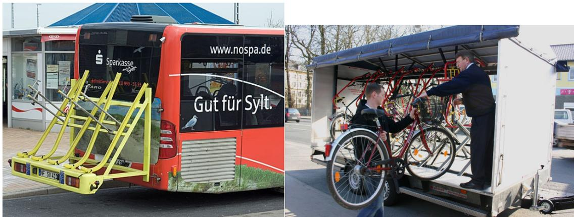
Abb. 55 Fahrradträgersystem am Beispiel von Sylt sowie Fahrradanhänger des Nahverkehrsverbundes Paderborn/Höxter
