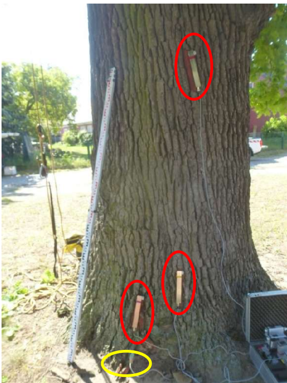
Foto 5: Messgeräte während des Zugversuches am Baum (Nordwestseite): Elastometer (Dehnungsmesser) – rot Inclinometer (Neigungsmesser) – gelb
