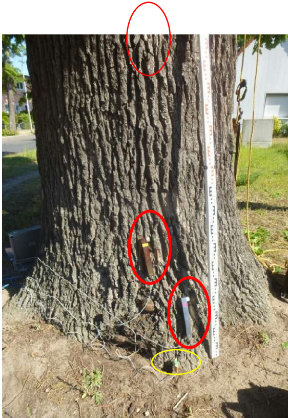
Foto 4: Messgeräte während des Zugversuches am Baum (Südostseite): Elastometer (Dehnungsmesser) – rot Inclinometer (Neigungsmesser) – gelb
