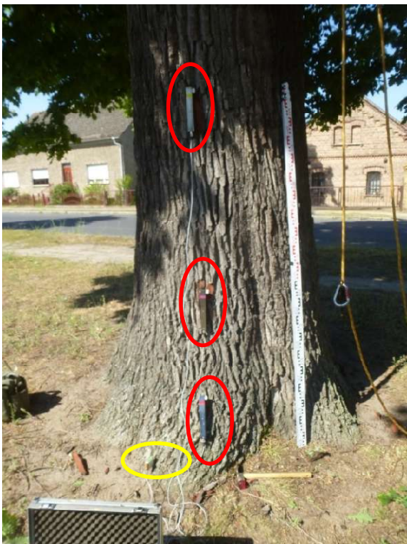
Foto 7: Messgeräte während des Zugversuches am Baum (Nordostseite): Elastometer (Dehnungsmesser) – rot Inclinometer (Neigungsmesser) – gelb
