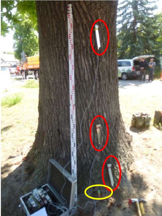
Foto 6: Messgeräte während des Zugversuches am Baum (Südwestseite): Elastometer (Dehnungsmesser) – rot Inclinometer (Neigungsmesser) – gelb
