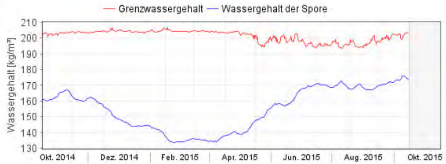
Abb. 31: Einer Spore zur Verfügung stehender Wassergehalt an der Innenoberfläche der Außenwand im Schlafzimmer Obergeschoss im Bestandsgebäude; Berechnet mit WUFI Bio [w27]. Der kritische Grenzwassergehalt für die Substratklasse I (gut verwertbare Substrate, wie z.B. Gipskarton) über dem biologische Aktivität einsetzt wird nicht überschritten.
